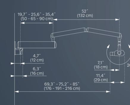
Nota: dimensioni basate su montaggio su singolo montante e cono corto. Il montaggio su due montanti si estende di ulteriori 1 1/4" (3,0 cm)
