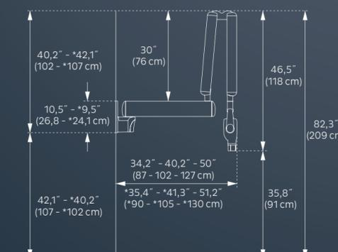
Nota: dimensioni basate su montaggio su singolo montante e cono corto. \* Indica dimensioni basate su montaggio su doppio montante.
