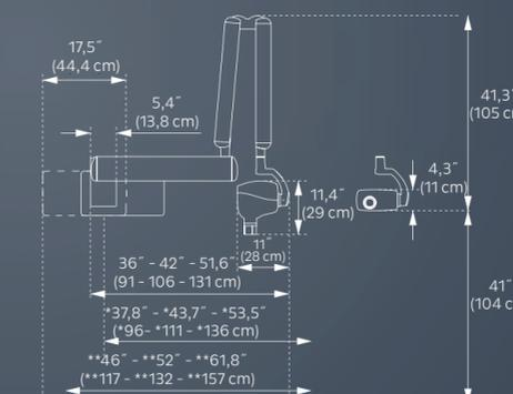
Nota: dimensioni basate su montaggio su singolo montante e cono corto. \* Indica dimensioni basate su montaggio su doppio montante, orientato a destra. \*\* Indica dimensioni basate su montaggio su doppio montante, orientato a sinistra.
